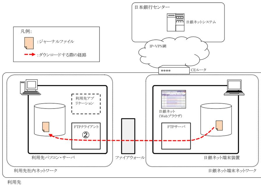
—— 照会データファイル取得機能により日銀ネット端末装置のハードディスクに格納した照会データファイルは、②と同様の操作により、利用先システムを構成するパソコンまたはサーバに取得することが可能です。
