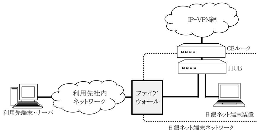
なお、日銀ネット端末ネットワーク内における機器の接続方法は、日銀ネット端末ネットワークと利用先社内ネットワークの間にファイアウォール専用機器を設置する構成であれば、上記例のほか、例えば「日銀ネット端末装置はHUBに接続するが、ファイアウォール専用装置はCEルータに直接接続する」等、設置場所や機器構成に応じた接続方法を選択することが可能です。
